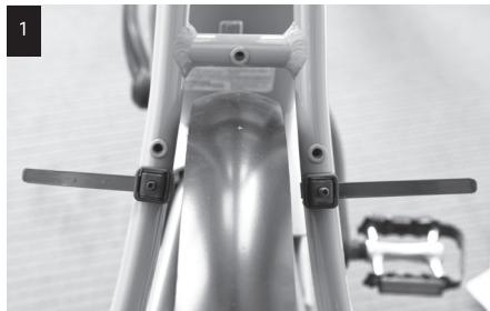
Die beiden Klebestreifen werden an die zukünftige Position der Spannbänder zum Schutz des Rahmens befestigt. Danach werden die Spannbänder (über die Klebestreifen) an der Sitzstrebe montiert.
