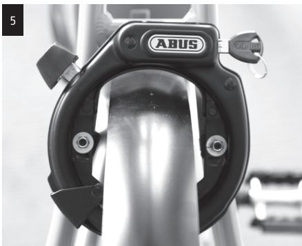
Beide Schrauben mit beigelegten Innensechskantschlüssel fest anziehen.
